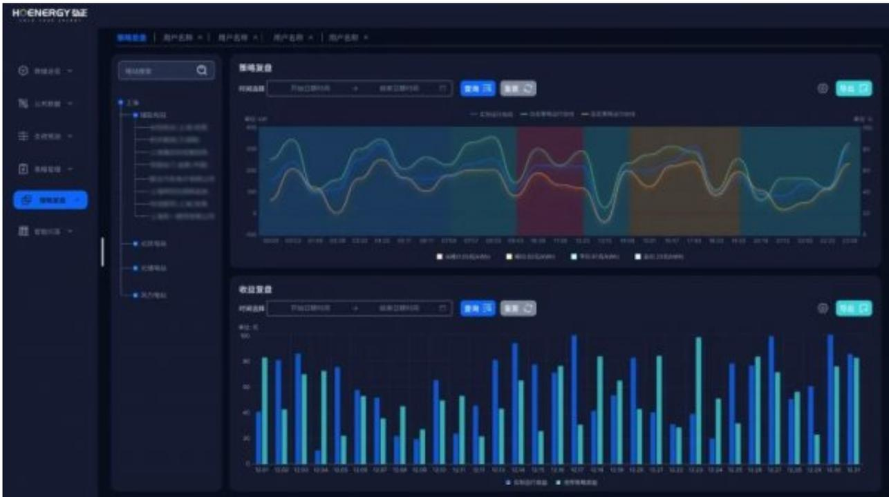
面对2025年江苏省电价政策调整带来的峰谷价差压缩挑战，弘正储能通过“技术+模式”双轮驱动策略，破局收益困境。项目搭载的EMS能量管理系统由弘正储能自主研发，以“秒级采集、毫秒级控制”的响应能力为支撑，深度融合削峰填谷、需量管理等多元能量调度策略与多时间尺度控制技术，同步集成智能预警与预测功能，实时解析负荷曲线、电价波动及设备健康度等关键数据，动态优化储能运行逻辑，智能生成兼顾经济性与安全性的最优充放策略，确保系统始终运行于最佳收益路径。
